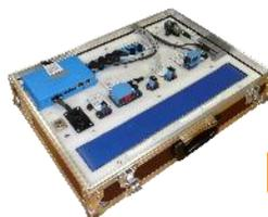
Complément Mallette passerelle Smart IoT Sick TDCE & Capteurs intelligents
