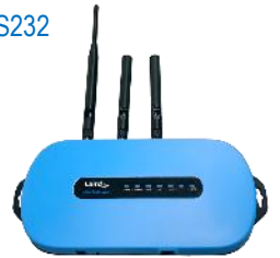
PR22 – Passerelle LoRa WAN « The Things Network »
