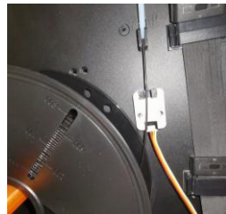
Imprimante 3D: capteur infra rouge pour détection présence du filament
