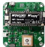
PR06 – Kit de développement ESP32 avec IoT LoRa WAN et GPS
