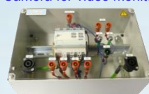
KNX module 4 digital outputs (KX01)
