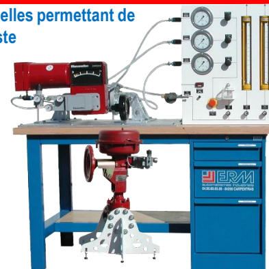
Vanne à sphère 1.5 pouce avec servomoteur électrique (vanne TOR)
