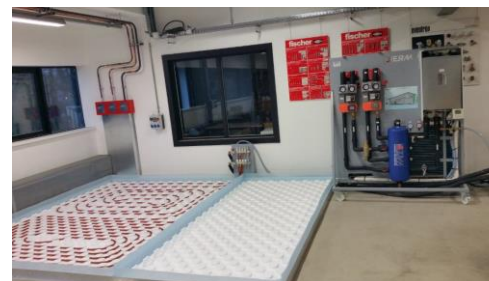
Banc Plancher chauffant hydraulique avec PAC Air/Eau 6kW réversible inverter
