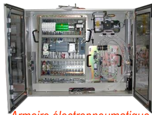
Armoire électropneumatique avec platines amovibles
