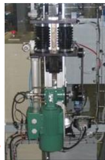
Centrale hydraulique proportionnelle
