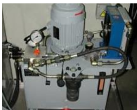
Centrale hydraulique proportionnelle
