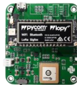
PR06 - Kit de développement ESP32 avec IoT LoRa WAN et GPS
