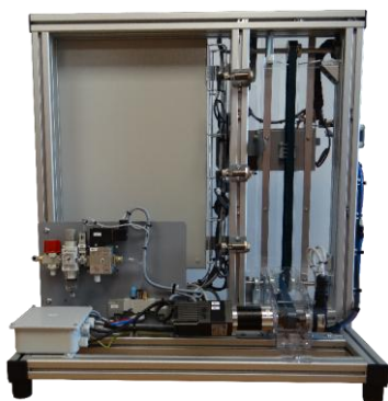
Partie opérative à technologie électropneumatique
