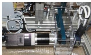
Motorisation Brushless, courroie crantée et codeur incrémental
