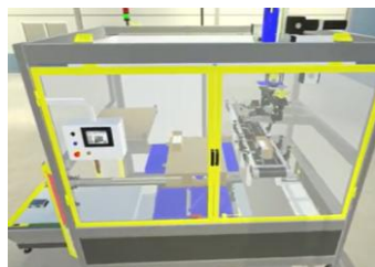
Jumeau numérique 3D programmable Palettiseur de cartons/barquettes
