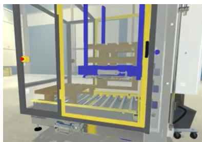
Jumeau numérique 3D programmable Multitec (Empileur et dépileur de palettes)
