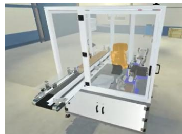
Jumeau numérique 3D programmable Robot 6 axes de conditionnement Ermaflex
