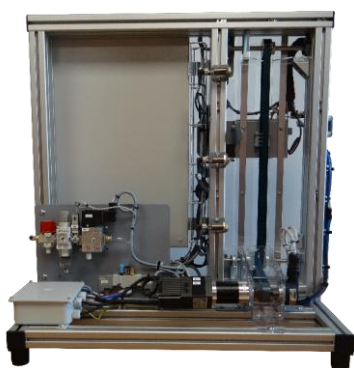
Partie opérative à technologie électropneumatique
