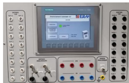
Interface de raccordement par fiches double-puits (fiches bananes) et connecteurs BNC écran tactile optionnel.
