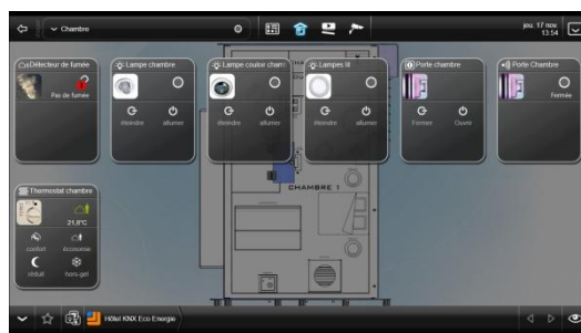
Ecran de commande des éléments : indication de l'état des luminaires et du thermostat
