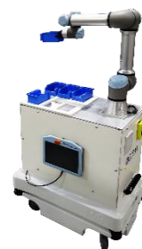
AGV MiR100 avec bras collaboratif UR eSeries
