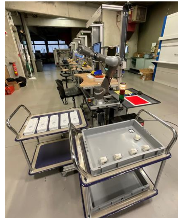
Station Cobot & Vision Omron TM en opération de conditionnement en fin d'assemblage
