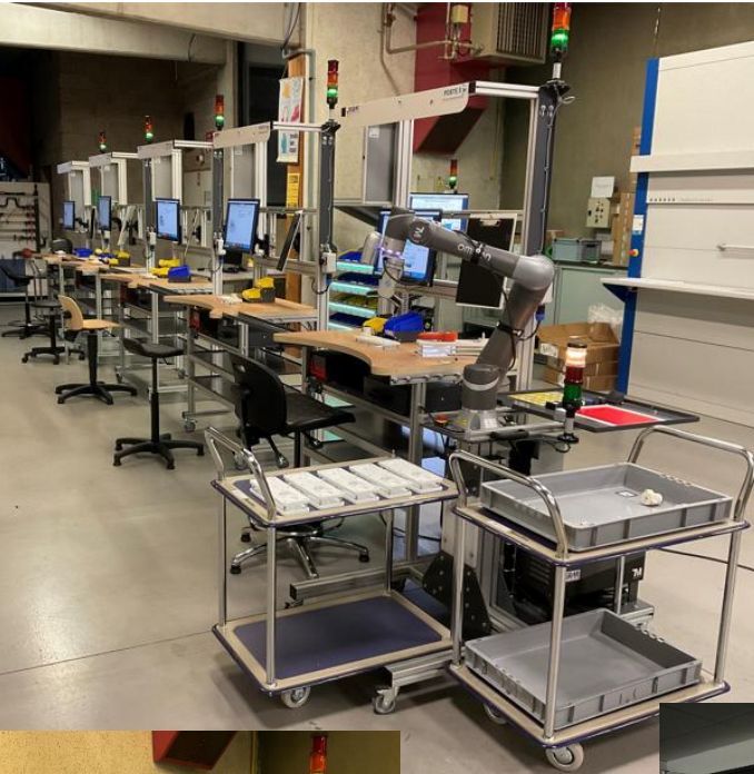
ErmaLean en configuration droite, avec Station Cobot & Vision Omron TM5
