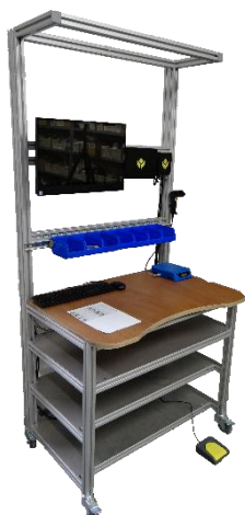
#1: Poste d'assemblage et contrôle qualité
