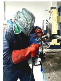
Exemples de simulation de soudage en temps réel dans le casque RA de Soldamatic
