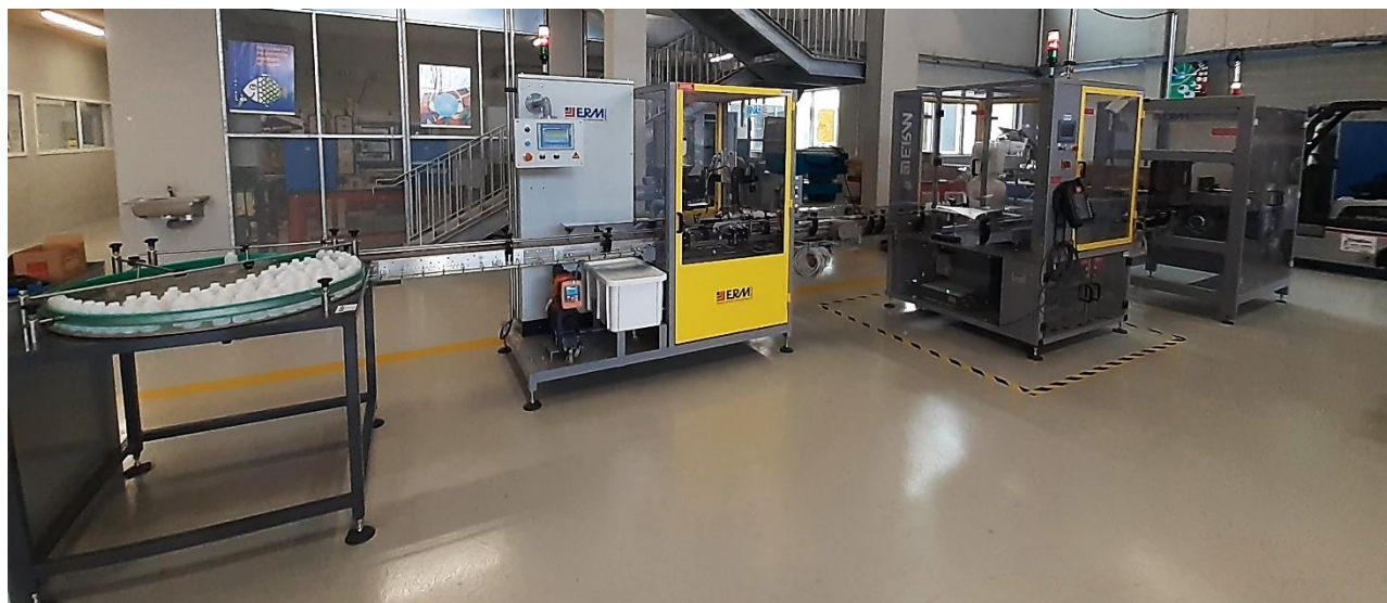
Cellule robotisée intégrée à la ligne Ermaflex
