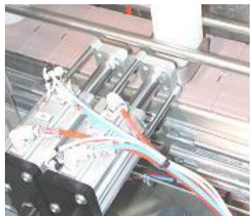
Vérin "Entrée, sas de dosage" et Vérin "Arrêt en position dosage"
