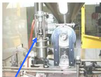
Vérin "Obturbateur sortie produit liquide"
