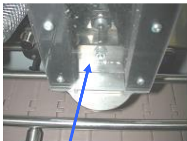
Vérin "obturateur sortie produit solide"
