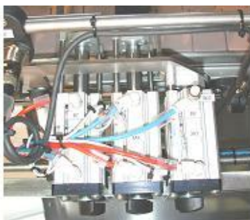
Vérin double taquets "Entrée et sortie sas de vissage" + Vérin "Indexage contenant Au sas de vissage" + Vérin "serrage au pote de vissage"
