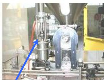
Vérin "Obturateur sortie produit liquide"
