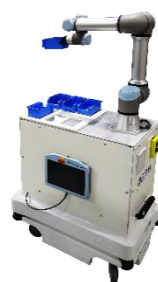
AGV MiR100 avec bras collaboratif UR eSeries
