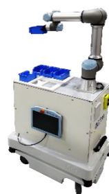
AGV Mir100 avec bras collaboratif UR eSeries
