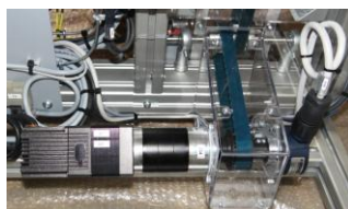
Motorisation Brushless, courroie crantée et codeur incrémental
