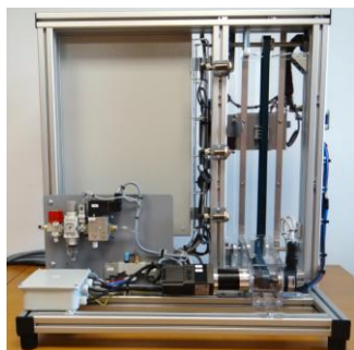
Partie opérative à technologie électropneumatique
