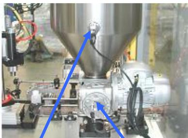
Capteur niveau cuve
