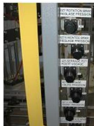
Régulateurs de pression situés à l'extérieur de la machine permettant de ajuster les réglages en cours de production
