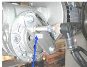
Capteur "Codeur rotation vis sans fin"
