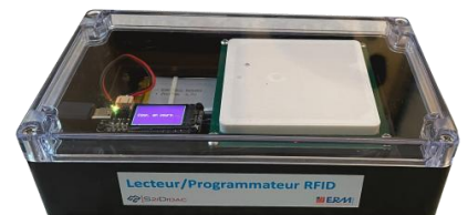
Lecteur /programmeur RFID Microcontrôleur Afficheur Led ESP 32-S3 TFT Feather Module YRM 100 UHF RFID Batterie
