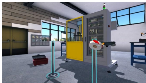
Illustration de la mise en place de la zone de balisage dans la scène 3D
