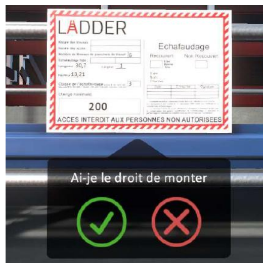
Vérification de la catégorie d'échafaudage
