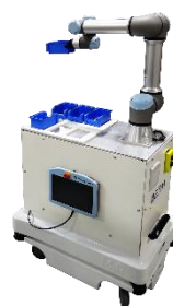
AGV Mir100 avec bras collaboratif UR eSeries
