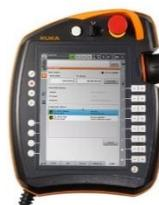
Pupitre tactile de commande du robot SmartPad
