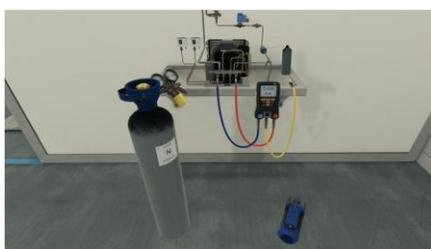
Procédez au contrôle d'étanchéité à l'aide du spray
