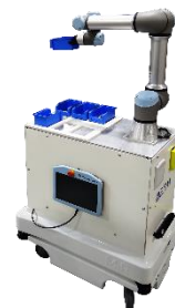
AGV MiR100 avec bras collaboratif UR eSeries
