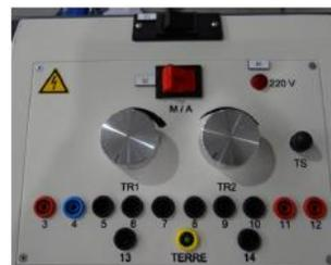
Le boitier de test permet de faire des mesures électriques afin de comprendre le fonctionnement du brûleur gaz et de rechercher les différents pannes
