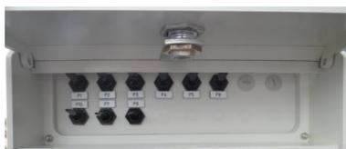
**Le coffret de pannes** est installé sur le côté gauche de la machine. 9 pannes sont réalisables. Les interrupteurs sont cachés de l'élève par un coffret verrouillable. Ce coffret permet l'approfondissement du cycle de fonctionnement et de créer des pannes qui nécessitent l'utilisation de contrôleurs (voir liste des pannes en page suivante)
