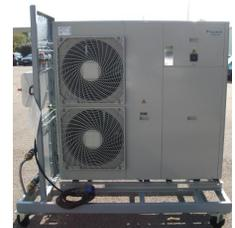
Ou option PC33 : Pompe à chaleur et ballon pour batterie froide et chaude sur châssis à placer dans l'atelier
