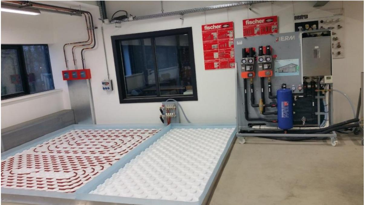
*Exemple d'installation de Banc Plancher chauffant hydraulique (PV20) avec PAC Air/Eau 6kW réversible inverter (PC60)*
