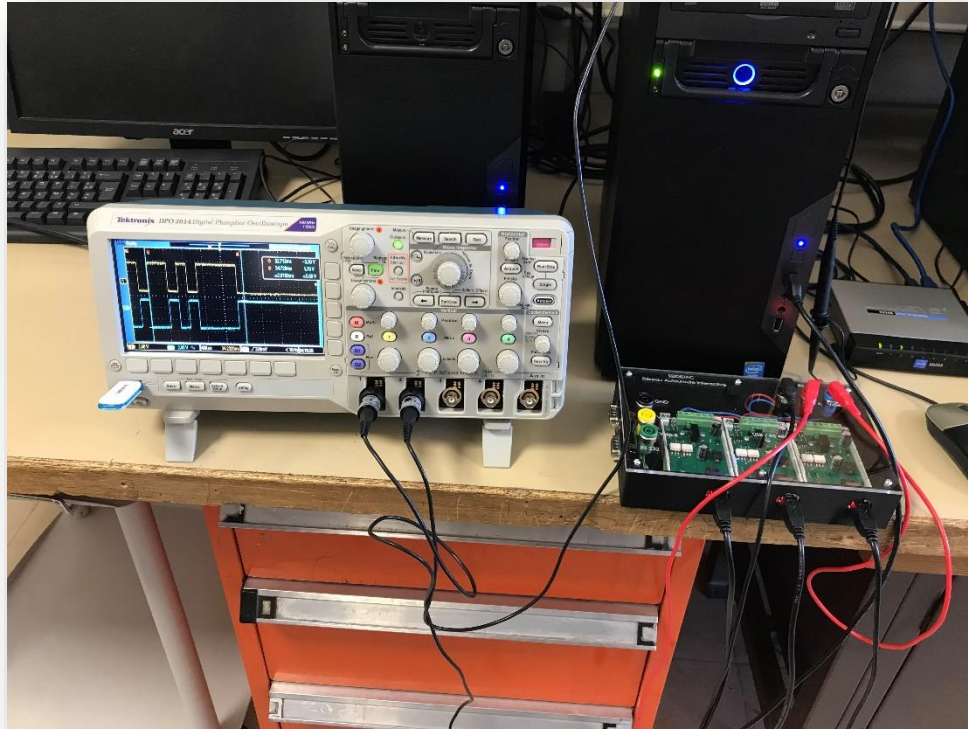
Exemple d'une acquisition d'une trame Modbus
