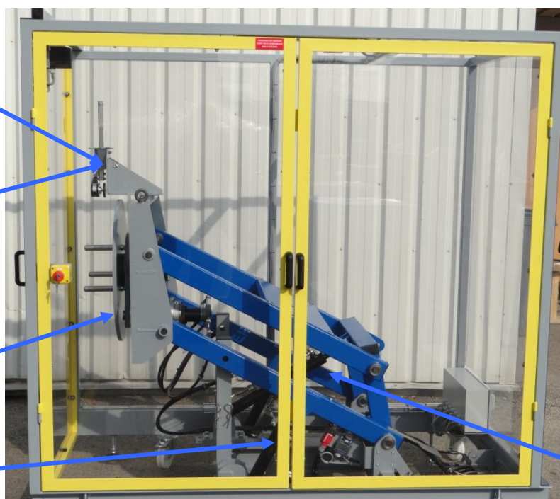
Positions extrêmes du Positionneur hydraulique 3 axes
