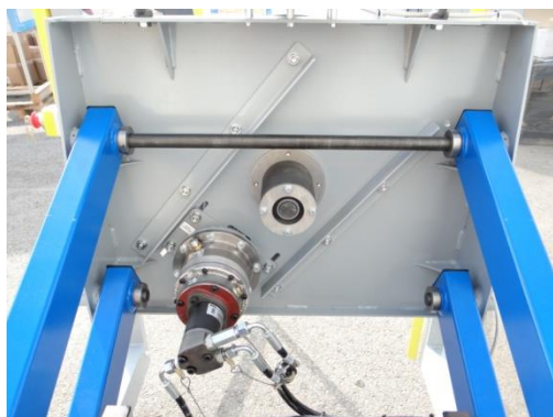
Un plateau rotatif avec moteur hydraulique
