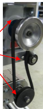
Remplacement de la transmission Pignons-Chaîne par Poulies-Courroie trapézoïdale
