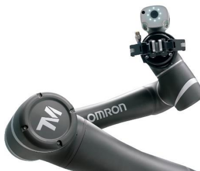
ON00: Station Cobot & Vision « Omron TM5 » avec châssis réglable en hauteur et plateau amovible
