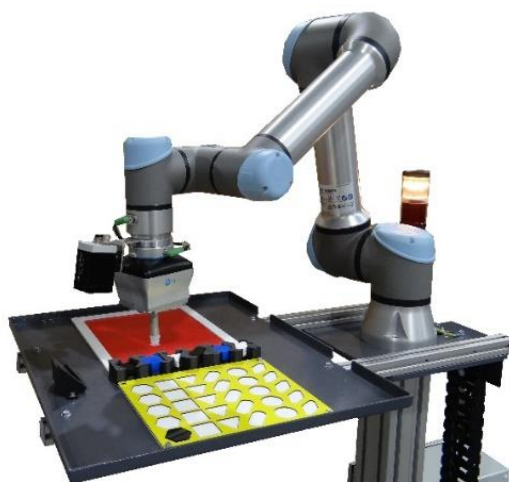
Station Cobot & Vision UR5 eSeries avec pièces pour projet de dévissage 2D et pick-and-place
