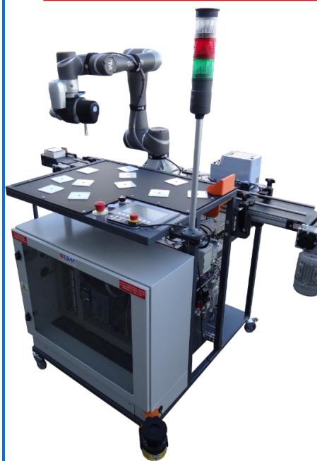
ON10: « Robot collaboratif de Dévissage 2D & Assemblage-Vissage » en configuration ErmaSmart Assemblage
