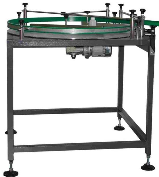
Table rotative d'accumulation en inox de 1 m de diamètre
