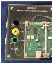
Vous brancherez les sondes de mesure sur les voies A et B de la liaison RS485 du boîtier convertisseur. L'acquisition devra se faire sur les deux voies !
