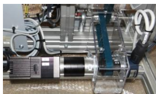
Motorisation Brushless, courroie crantée et codeur incrémental
