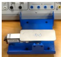
Jauge de contrainte sur le poste de pesage
