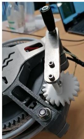
Une fois la manivelle mise en place, l'entraînement de la roue de la génératrice permet de rembobiner la grande courroie.
