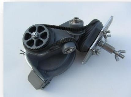
L'évolution s'est principalement concentrée sur l'optimisation de la structure aéroportée. En effet, une pièce concentre le châssis et les poulies de transmission sont crantées. Seules les poulies de transfert sont lisses.
