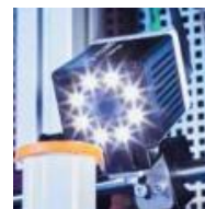
Capteur de vision avec éclairage LED intégré
