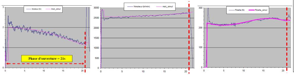
On constate que grandeurs simulées MATLAB superposent avec une assez bonne précision (de l'ordre de qques % d'écart maxi) sur les grandeurs mesurées jusqu'à l'arrivée en butée. Le modèle est
