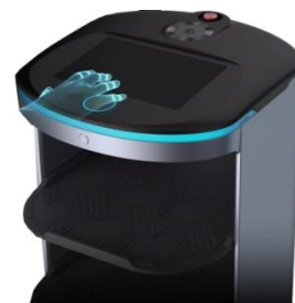
Une interface tactile couleur située sur la partie supérieure
