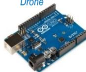
Carte Arduino pour le pilotage de la nacelle de prise de vue
