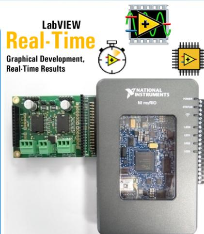
Coffret N.I. myRIO de contrôle et d'acquisition temps réel (réf: NC00)
