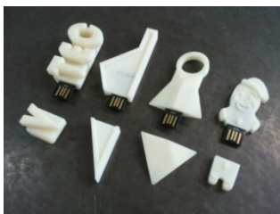
Exemples de clés USB réalisées par moulage à partir de modèles prototypés
