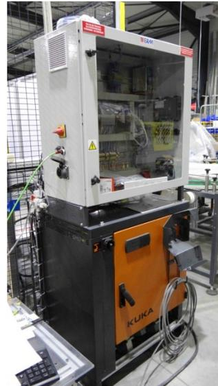
Coffret de puissance et de commande & Baie de commande du robot
