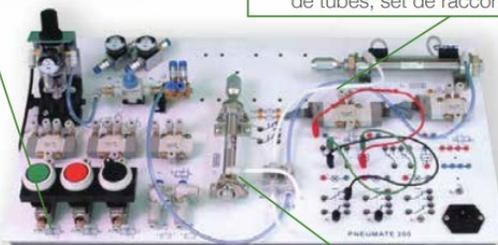
Composants avec raccordement pour tube de 4mm
