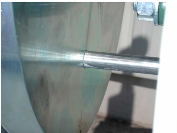
Sortir la pige par le trou du châssis du coté système de consignation mécanique :
